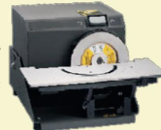
Машина для притирки инструмента AccuFinish (чтобы обеспечить более длительный срок службы наконечников инструментов)
